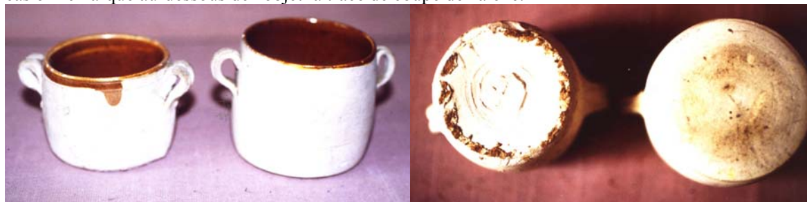
L'objet de gauche est livré brut de coupe de l'alêne et en porte les traces, celui de droite a été tournazé.
